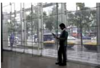
P41_wdr1: Toma Cámara Convencional SIN WDR - La imagen es oscura y no se puede definir el sujeto.
